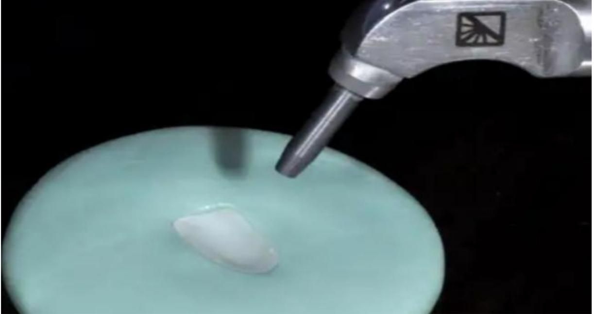
Figura11: Exemplo de jateamento de superfície cerâmica com óxido de sílica (silicatização) feito com Conjet (3M Espe) com aparelho de microjato (Ivoclar/Vivadent)
